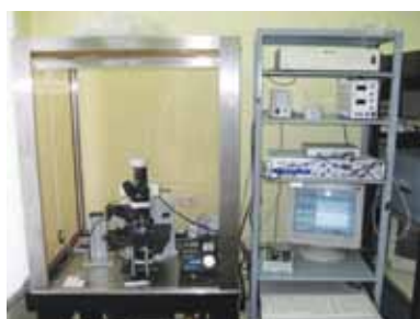
Комплекс для микроэлектродных исследований клеток
