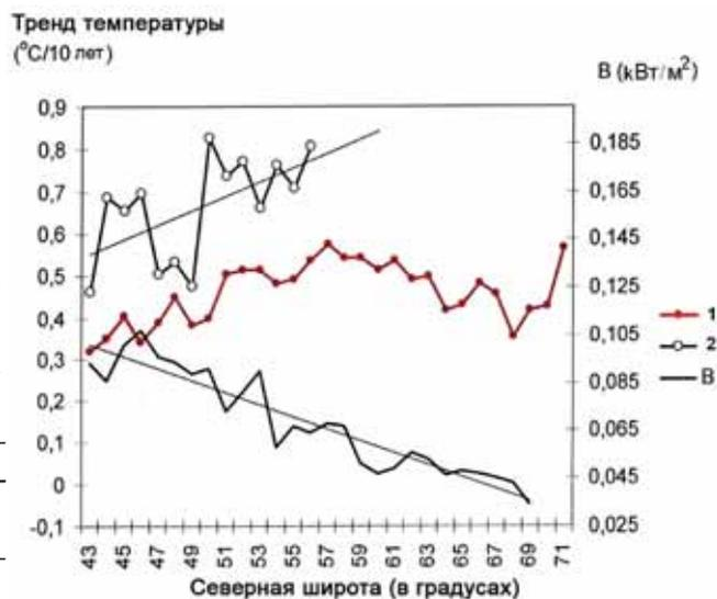
Рис. 6. Зональное осреднение радиационного баланса (B) и трендов температуры при облачной (1) и безоблачной (< 2 баллов) погоде в зависимости от широты (1966–2005 гг.)
