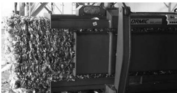
Рис. 4. Брикетирование отходов
