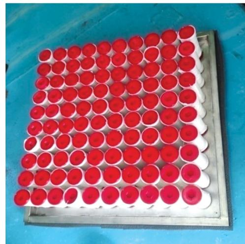
Устройство для тонкой очистки воздуха в процессе аэробного культивирования хлебопекарских дрожжей
