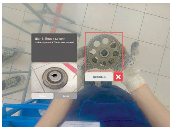
В смарт-очках перед глазами рабочего задача с подробной инструкцией
