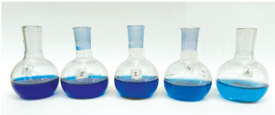
Изменение интенсивности растворов метиленового голубого после контакта с азотированным активированным антрацитом: 1 — исходный раствор; 2 — раствор через 3 минуты; 3 — раствор через 7 минут; 4 — раствор через 10 минут; 5 — раствор через 15 минут
