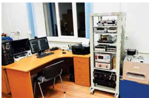
Рис. 50. Национальный эталон единиц мощности удельных магнитных потерь и магнитной индукции переменного магнитного поля в диапазоне частот от 50 Гц до 200 кГц
