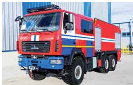
Рис. 62. Облегченная пожарная автоцистерна на полноприводном шасси МАЗ с централизованной подкачкой шин
