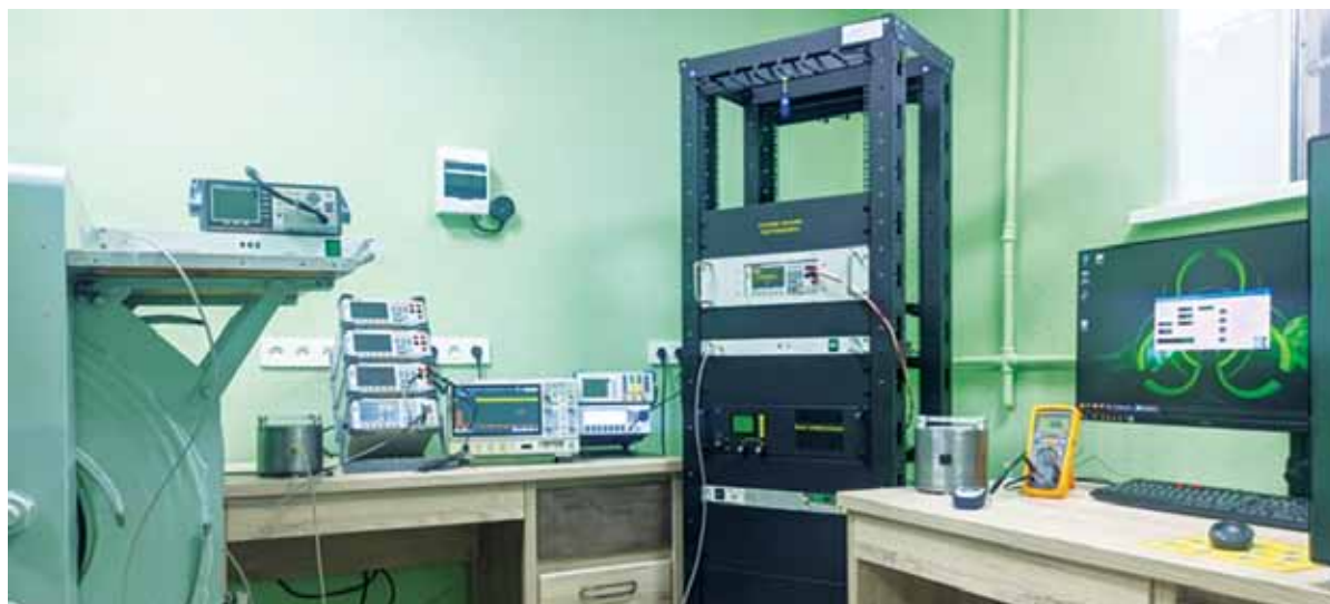
Рис. 52. Модернизированный Национальный эталон единицы магнитной индукции Тесла в диапазоне (0,05–2,00) Тл
