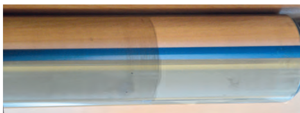
Участок плунжера, подвергнутый МАО
