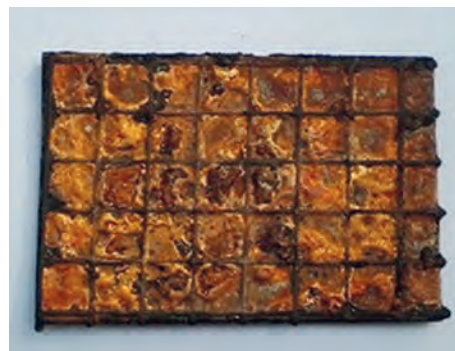
Образец после индукционной наплавки перед механической обработкой
