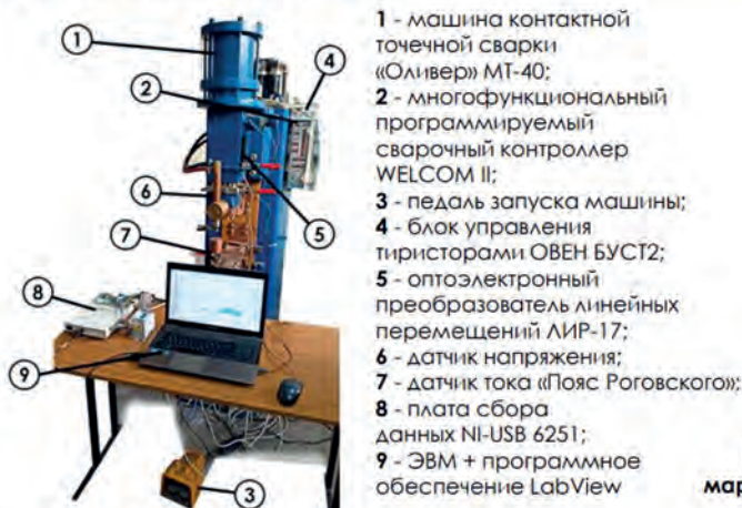
Установка, для реализации системы программного управления процессом контактной рельефной сварки
