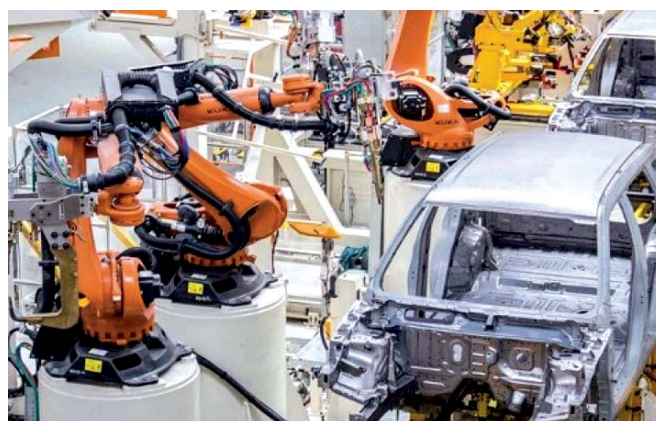
Рис. 57. Роботизированная линия мелкоузловой сварки транспортных средств марки Geely
