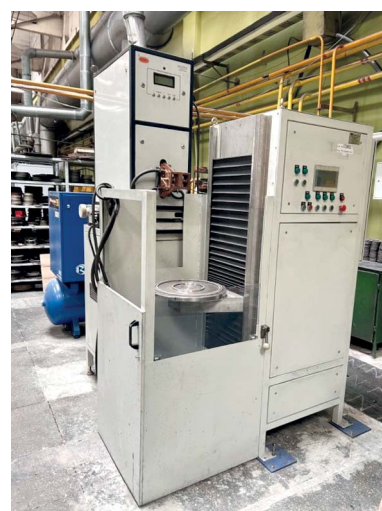
Рис. 64. Технологическое оборудование для термообработки зубчатого профиля фрикционных дисков
