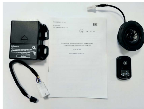
Рис. 59. Система тревожного оповещения
