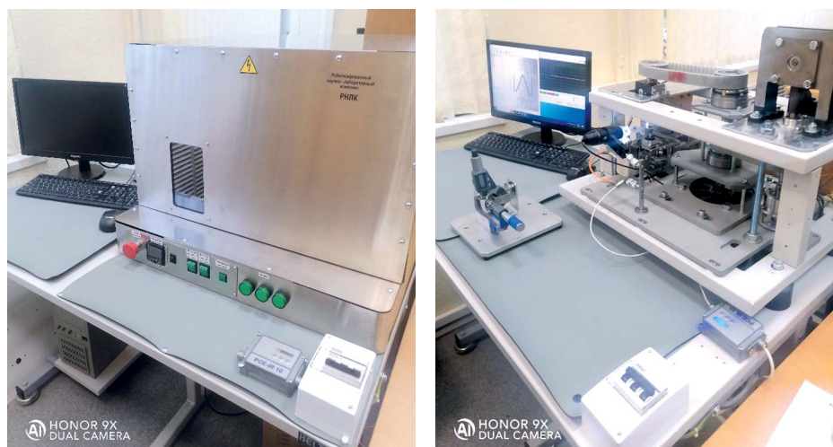
Рис. 72. Настольный модульный роботизированный научно-лабораторный комплекс для усталостных и триботехнических ускоренных испытаний и экспресс-анализа конструкционных, смазочных материалов и покрытий
