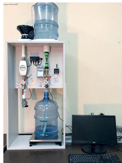
Рис. 67. Научно-учебный программно-аппаратный комплекс для изучения и исследования характеристик ультразвуковых смарт-приборов учета энергоносителей и систем передачи данных по технологии «умный дом»
