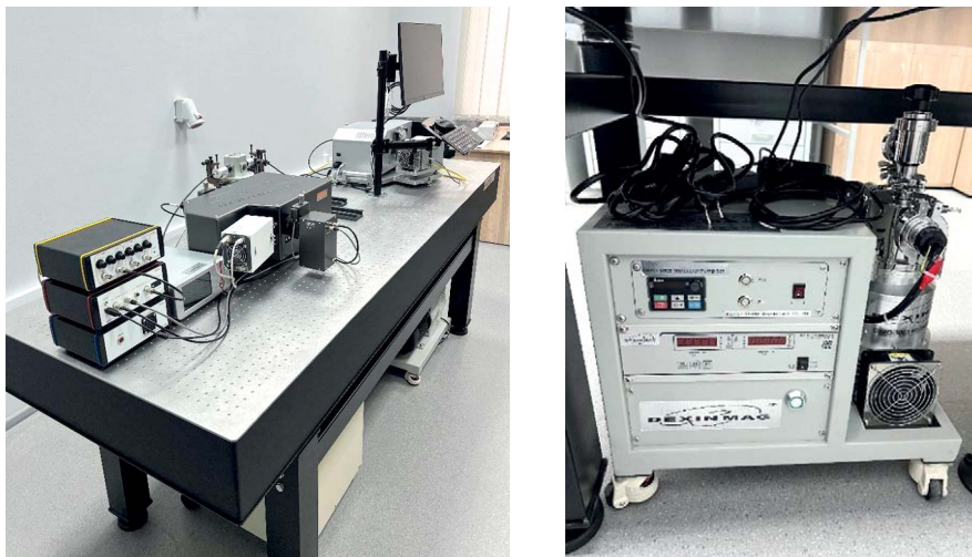
Рис. 66. Научно-учебный аналитический комплекс для исследования динамики люминесценции и фотопоглощения полупроводниковых структур в широком интервале температур
