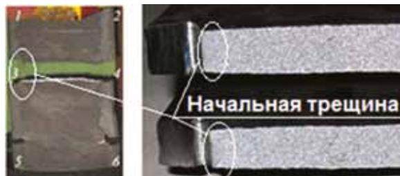
Рис. 2. Изломы стального листового элемента с боковыми надрезами
