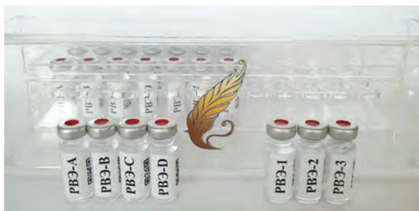
Стандартные образцы водно-этанольных растворов летучих компонентов для прямого количественного определения летучих компонентов в широком спектре матриц алкогольной и этанолсодержащей продукции
