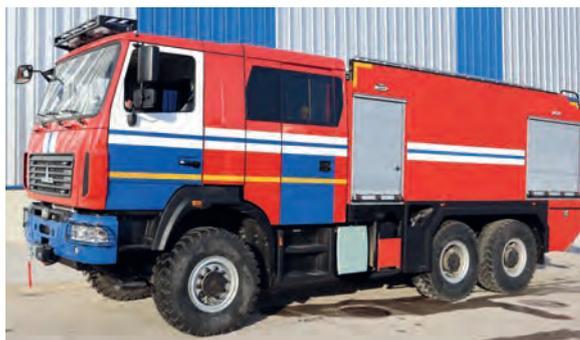
**ОБЛЕГЧЕННАЯ ПОЖАРНАЯ АВТОЦИСТЕРНА АЦ 8,0-40 (6302) НА БАЗЕ ШАССИ МАЗ С ЦЕНТРАЛИЗОВАННОЙ ПОДКАЧКОЙ ШИН**
