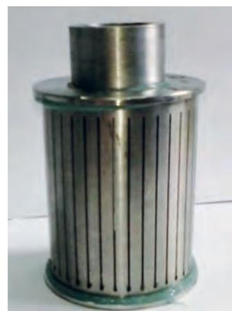
Модель для проведения гидро-, и (или) пневматических испытаний
