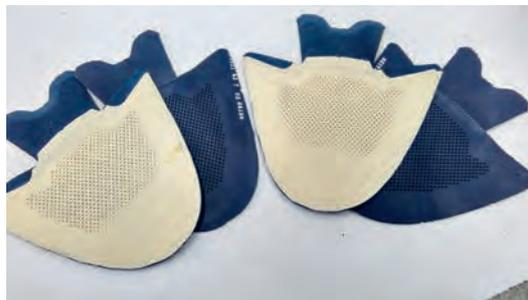
Рис. 4. Перфорация деталей заготовки верха обуви, изготовленная с помощью разработанной оснастки
