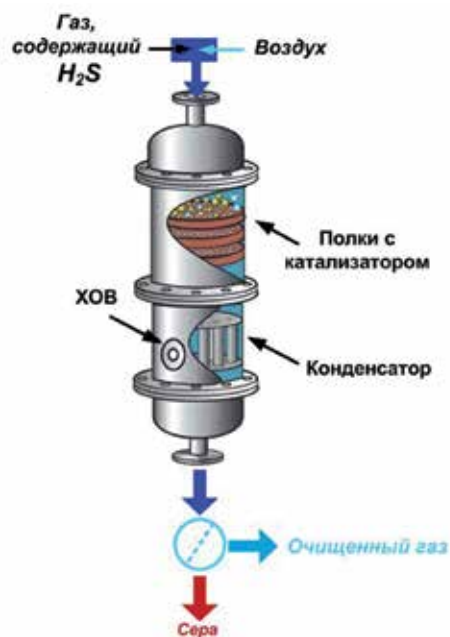
Технология переработки сероводорода с получением элементарной серы. Модификация 2
