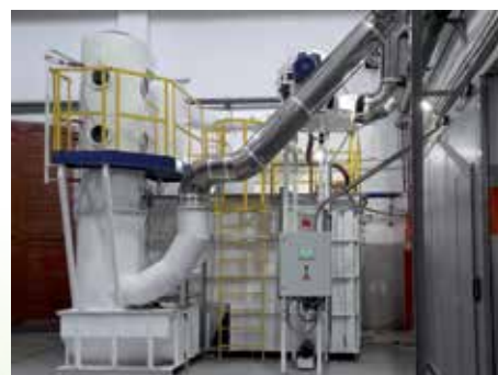
1 – скруббер с массообменными решетками и насадкой; 2 – насос; 3 – биореактор с насадкой и аэраторами; 4 – вентилятор; А и В – вход и выход вентиляционного С – водный абсорбент
