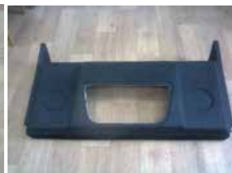
Лист и деталь потолка из ДПК (кабина трактора МТЗ)
