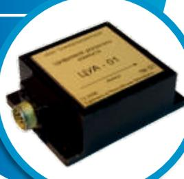
предназначен для измерения направления на магнитный север
