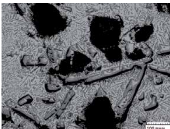
Результаты оптического металлографического анализа композитов с содержанием алюмооксидной фазы до 15 %
