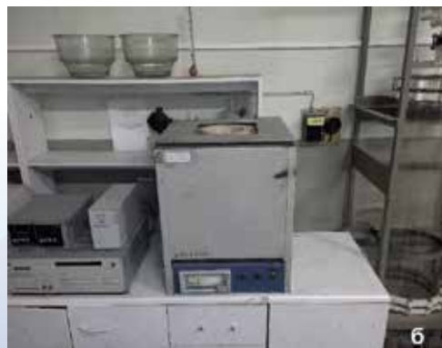
Плавильное оборудование: а — индукционная вакуумная печь; б — муфельная электрическая печь сопротивления
