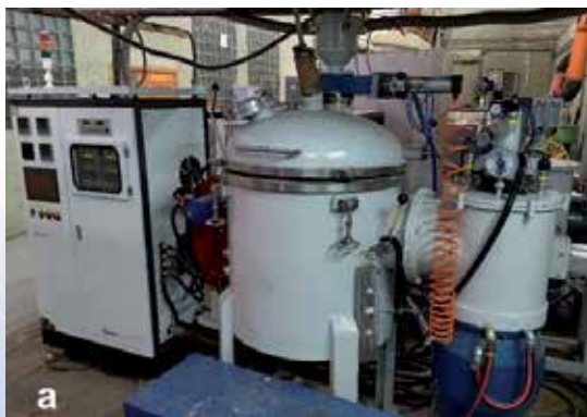
Плавильное оборудование: а — индукционная вакуумная печь; б — муфельная электрическая печь сопротивления
