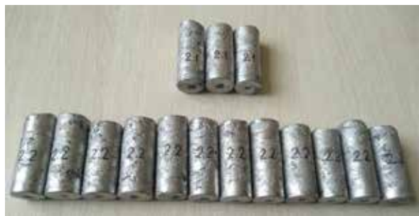
Образцы композиционных сплавов, полученные с использованием крупнодисперсного кварцевого песка из жидко-твердофазной композиции
