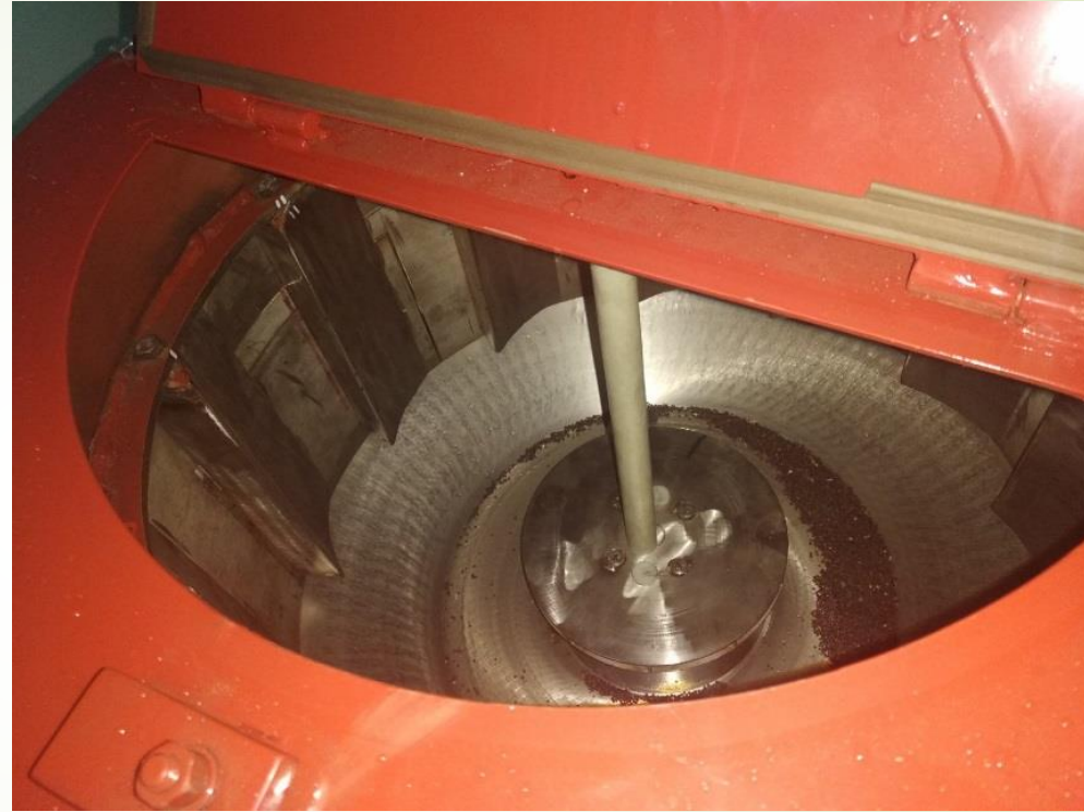
Камера смешивания экспериментального дражжиратора
