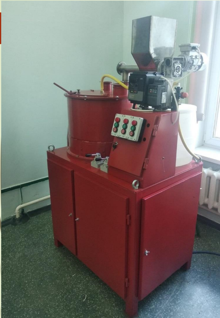
Камера смешивания экспериментального дражжиратора
