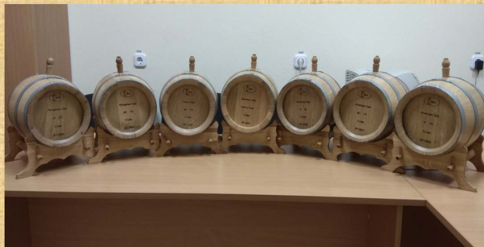
Бочки из дуба различного происхождения и с различной степенью обжига, используемые для отработки технологических параметров выдержки в лабораторных условиях.
