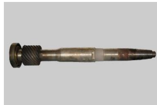
Восстановление размеров деталей в местах установки подшипников качения
