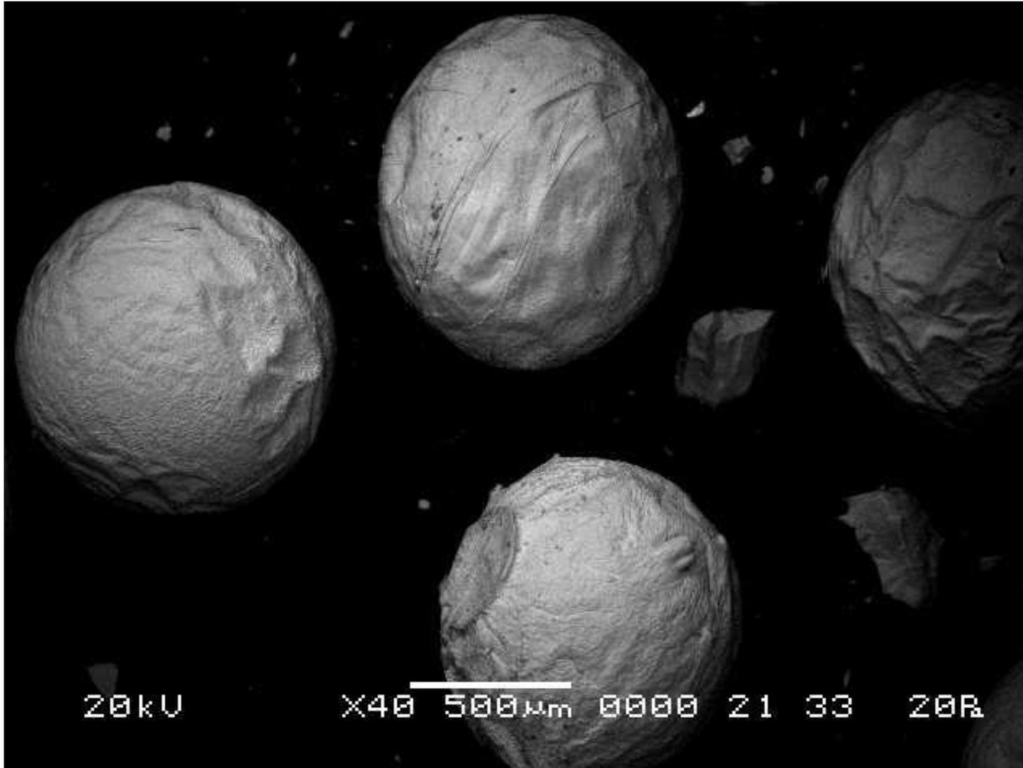
Высокопрочные стеклокерамические пропанты обладают высокой сферичностью и округлостью, которые составляют 0,97 усл. ед. Высокие сферичность и округлость достигается благодаря использованию метода диспергирования струи расплава на капли.
