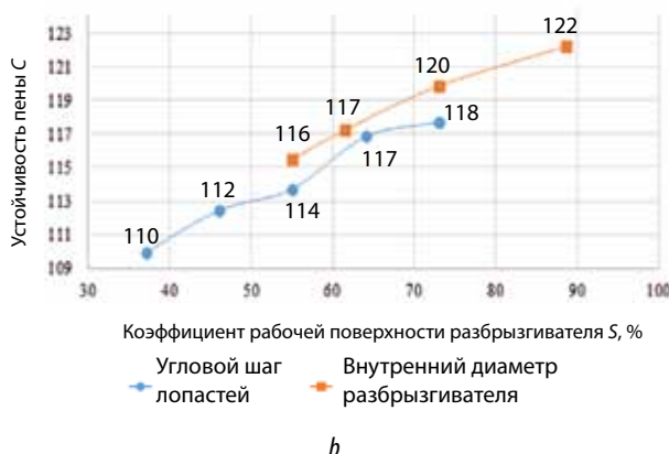
Рис. 5. Зависимость кратности (a) и устойчивости (b) пены от коэффициента рабочей поверхности разбрызгивателя
