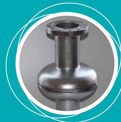
Эллиптический 1,3 МГц сверхпроводящий резонатор из особо чистого ниобия, изготовленный с использованием электронно-лучевой сварки
