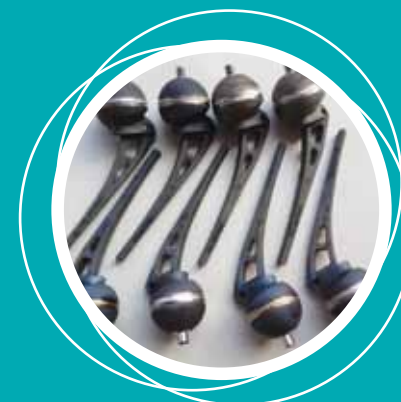
Заготовки эндопротезов тазобедренного сустава из сплава Co — Cr — Mo, изготовленные с использованием электронно-лучевой сварки
