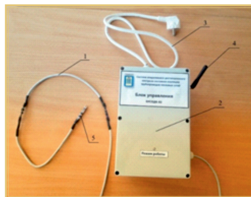
ЦИФРОВАЯ СОДК: 1 – ПРОВОДНИК СИСТЕМЫ КОНТРОЛЯ, 2 – КОРПУС БЛОКА УПРАВЛЕНИЯ, 3 – СЕТЕВОЙ ШНУР, 4 – АНТЕННА GSM МОДУЛЯ
