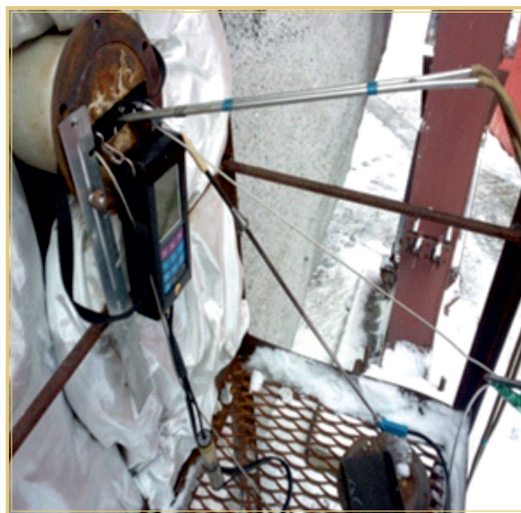
СХЕМА ИСПОЛЬЗОВАНИЯ ГИБКОГО ЗОНДА С ТРОСАМИ В ДЫМОВЫХ ГАЗАХ КОТЛОАГРЕГАТА (В КОМПЛЕКТЕ С ГАЗОАНАЛИЗАТОРОМ MULTILYZER)
