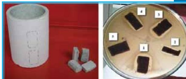
**ОПРЕДЕЛЕНИЕ БИОЦИДНОЙ АКТИВНОСТИ ПОВЕРХНОСТИ ФИЛЬТРОЭЛЕМЕНТОВ ДИФУЗИОННЫМ МЕТОДОМ (ЗАМЕДЛЕНИЕ РОСТА ТЕСТ-БАКТЕРИЙ АА1: ОБРАЗЦЫ № 1–4 — С БИОЦИДОМ, № 5 — БЕЗ БИОЦИДА)**
