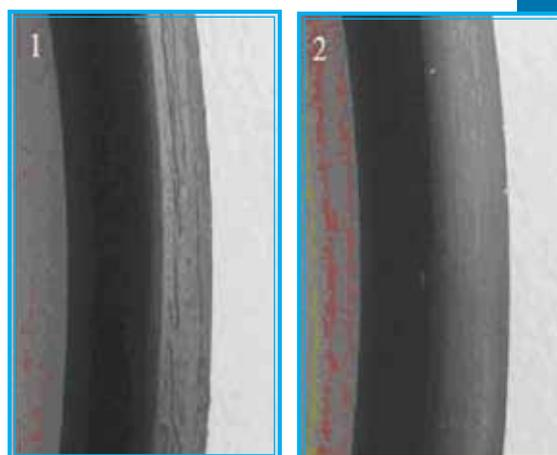
**ПОВЕРХНОСТЬ МАНЖЕТ ПОСЛЕ 750 ТЫС. ЦИКЛОВ ИСПЫТАНИЯ**
