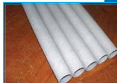
**ОБРАЗЦЫ ПОРИСТОЙ КЕРАМИКИ ТРУБЧАТОЙ ФОРМЫ (ДЛИНА — 500 ММ, ДИАМЕТР — 65 ММ)**
