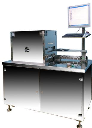
**Установка диффузионной сварки подложек МСТУ ЭМ-4044**
