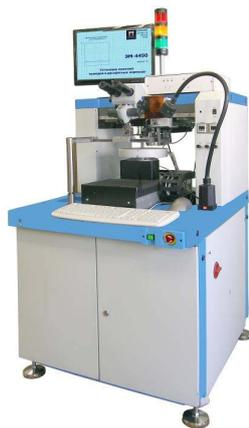
**Установка монтажа выводов в дискретных корпусах ЭМ-4450**
