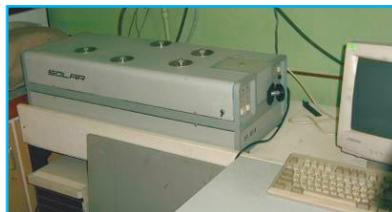
Отношение сигнал/шум, определяемое по рамановскому спектру дистиллированной воды при возбуждении на длине волны 350 нм, при спектральной ширине щелей монохроматоров 5 нм..... не менее 60:1
