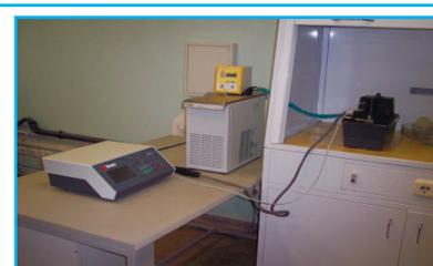
Установка для электролитического утонения TenuPol-5
