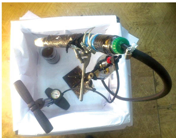
Установка для создания давления масла в кабеле с использованием ручного насоса
