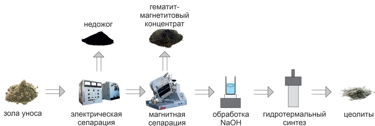
Схема переработки золы уноса
